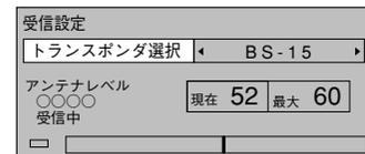
アンテナ入力レベルの動きを見て、アンテナが動作しているかを確認する
