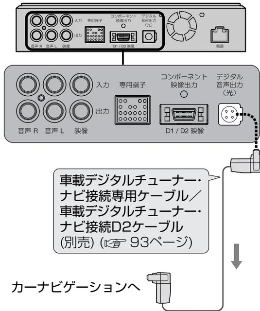
車載デジタルチューナー・ナビ接続専用ケーブル／車載デジタルチューナー・ナビ接続D2ケーブル (別売) (☞ 93ページ)
