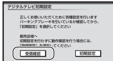
2 ◀▶を押し、物理チャンネルの受信レベル(色表示)が表示されるチャンネルで確認する
