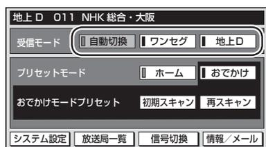
●「自動切換」に設定すると地上デジタルテレビ放送番組を視聴中に、受信状況が悪化したときには、自動的にワンセグの番組に切り換え、地上デジタルテレビ放送が受信できるようになれば、自動的に地上デジタルテレビ放送の番組に切り換えます。
