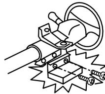
ステアリングやブレーキなどの保安部品のボルトやナットを使用して取り付けたら、事故の原因となります。
