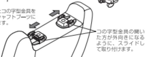
コの字型金具の開いた方が外向きになるように、スライドして取り付けます。
