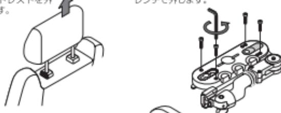
③取り外したコの字型金具をシートのシャフトブーツに取り付けます。
