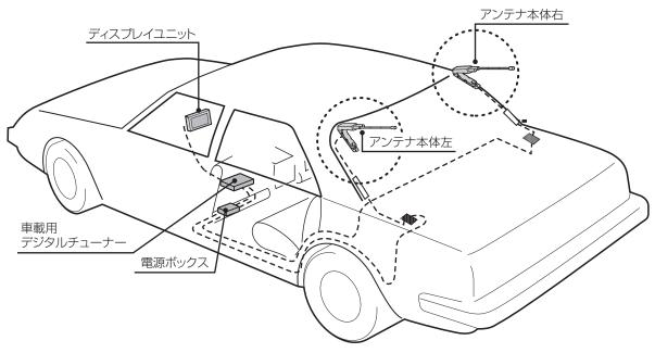
6 アンテナ本体をアンテナベースに取り付ける
