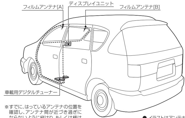
※すでに、はっているアンテナの位置を確認し、アンテナ間が近づき過ぎにならないように縦はり、もしくは横はりを組み合わせてください。
