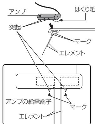
アンプ[A]のはくり紙をはがして、エレメントの給電端子接触部の小さなマーク(▲印)とアンプの給電端子の先端の突起を合わせてはり付けます。
