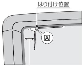
しないように注意して、ゆっくりと端からはり付けます。はり付け後、エレメント上を強く押えてエレメントをガラスに密着させます。
