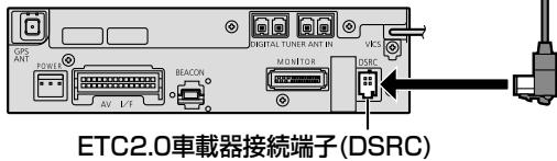
ETC2.0車載器接続端子(DSRC)
